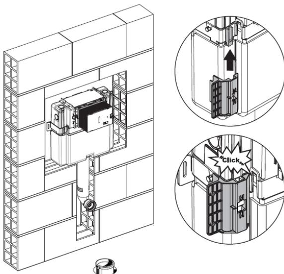
Per una corretta installazione si deve posizionare la cassetta EXPERT EVO all'interno del muro utilizzando le protezioni in dotazione montate precedentemente. Utilizzare le squadrette per ancorare la cassetta parallela al piano del muro.
